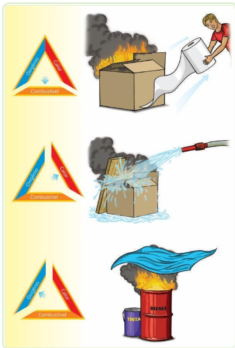
Figura 1.9: Extinção de incêndio
