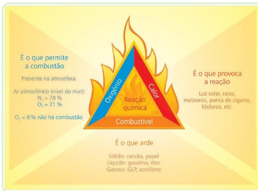
O combustível somente entra em ignição se estiver no estado gasoso, se estiver em estado sólido ou líquido, haverá a necessidade da fonte de calor aquecer a substância, que a partir de então emanará vapores de combustível, e estes terão condições de entrar em ignição. Exemplos de combustíveis são os óleos lubrificantes, óleos vegetais e glicerina. Qualquer combustível líquido, suficientemente aquecido, torna-se inflamável (VENDRAME, 2013).
